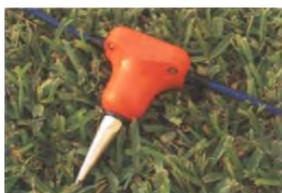
Per registrare le vibrazioni del terreno sono stati utilizzati 12 e 24 geofoni del tipo elettromagnetico a bobina mobile con frequenza caratteristica di 12 Hz, che consentono di convertire in segnali elettrici gli spostamenti che si verificano nel terreno. Questi ricevitori erano collegati al sismografo tramite degli appositi cavi multipolari.
